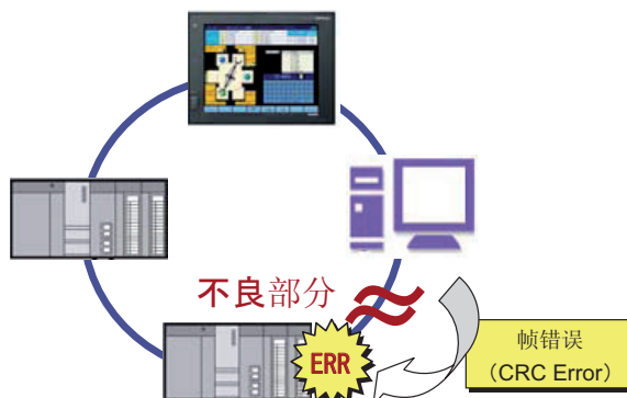
图7电缆不良部分的特别指出
